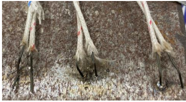
※0.65mm熱電対溶接例
