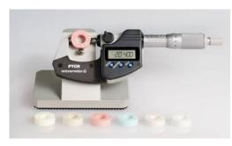
正確な収縮寸法測定の為にPTCRの位置決め治具と 測定したデータ転送を行うUSBインターフェースを 備えたデジタルマイクロメーターを保持する専用 ホルダーも提供しています。この専用ホルダーにより 再現性のある位置決めが保証されます。
